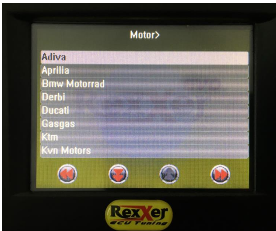
Abbildung 2: Fahrzeugauswahl: Im nächsten Fenster wird das angeschlossene Fahrzeug ausgewählt. Mit den nach rechts zeigenden Pfeilen wird zunächst die Marke und dann das Modell ausgewählt.
