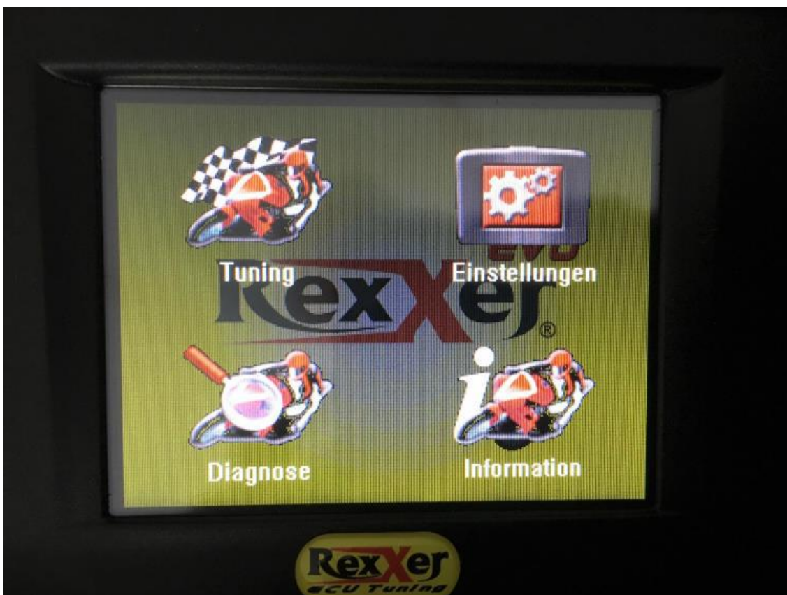
Abbildung 1: Hauptmenü: Öffnet sich nachdem das Schnittstellenkabel mit dem OBD-Stecker des Motorrades und dem RexXer EVO User verbunden ist automatisch.
