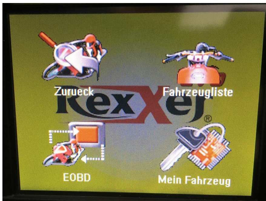
Abbildung 8: Menüpunkt Diagnose: Unter dem Punkt „mein Fahrzeug“ können Sie Servicefunktionen nutzen. Wird Ihr Fahrzeug nicht erkannt, können Sie unter dem Punkt „Fahrzeugliste“ Ihr Fahrzeug direkt auswählen.
